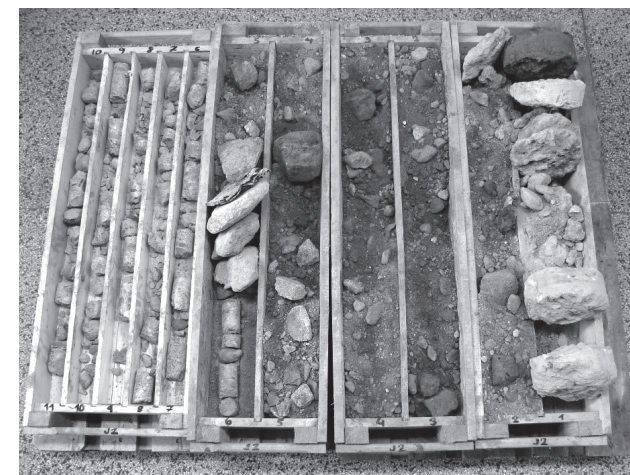
Hloubkové jádrové vrty do pilíře, základu až do podloží. Vzorokovnice s vnesenými jádry vrt v oblasti pilíře 3 při číslování z holešovické strany.
