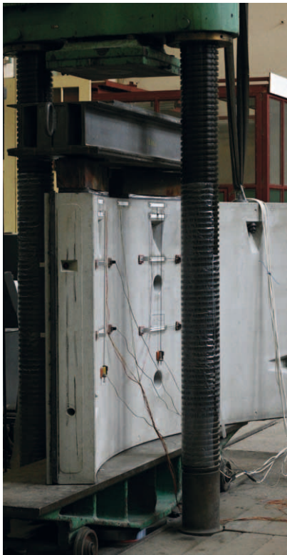
Zkouška segmentu ostění nové trasy metra A
