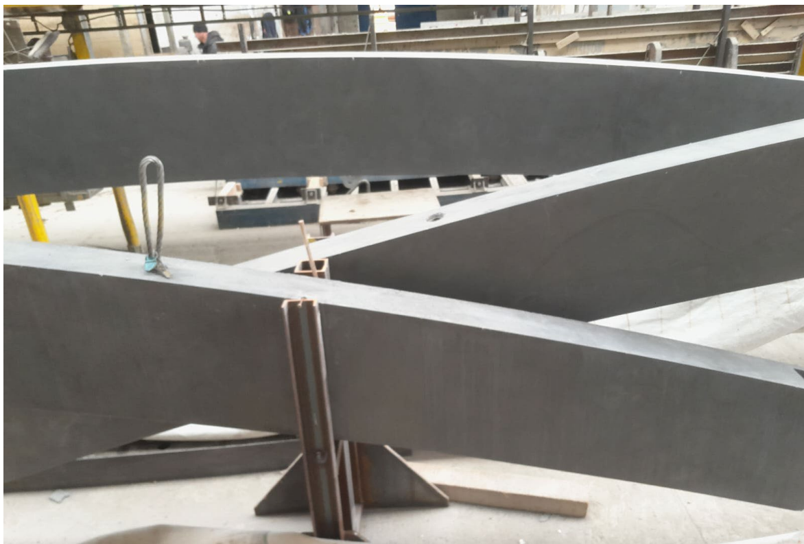
Obr. 5 Prefabrikáty oblouků ve stojanech ve výrobě KŠ PREFA Tovačov
