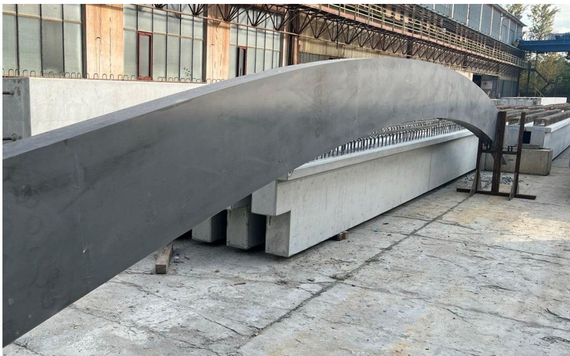
Obr. 7 Prefabrikát oblouku ve stojanu ve výrobě KŠ PREFA Tovačov
