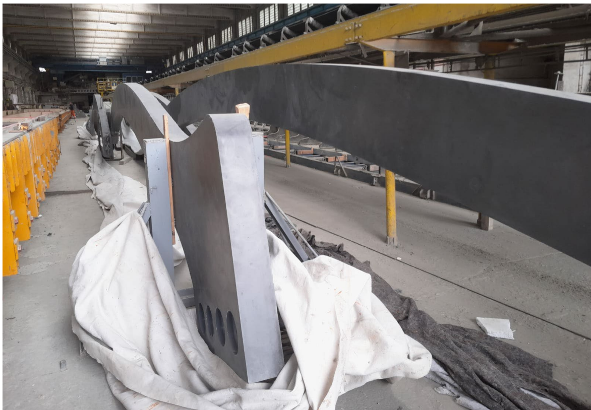
Obr. 6 Prefabrikáty oblouků ve stojanech ve výrobě KŠ PREFA Tovačov
