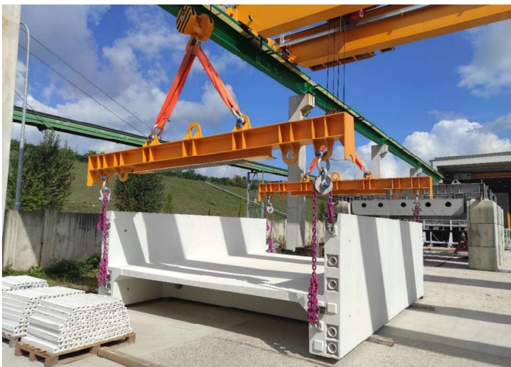
Obr. 7 Segment na kladkových závěsech ve výrobě KŠ PREFA Štětí
