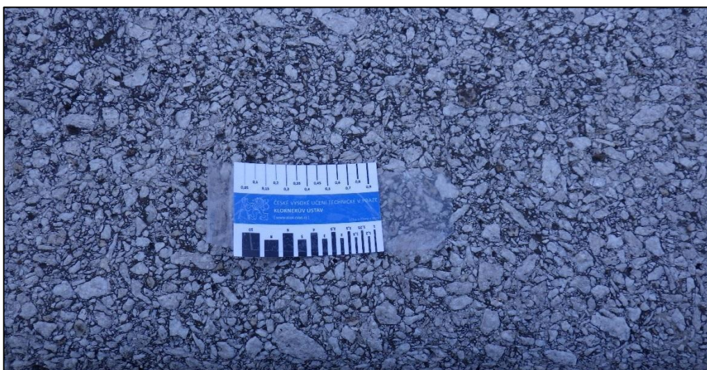
obr.12. Příklad plniva jemnější struktury s ojedinělými většími zrny
