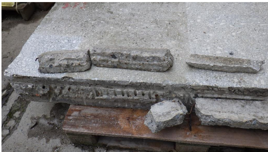
obr.28. Velmi slabě vyztužené pero panelu po odříznutí a odvrtání od deskové části
