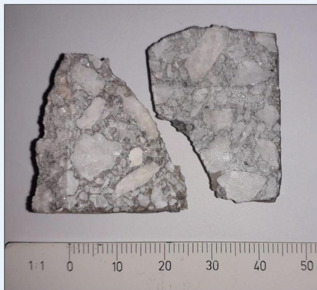
Foto 1. Makrofotografie odebraného vzorku betonu z Libeňského mostu. V rámci odebraného vzorku betonu jsou v základní hmotě zastoupeny prakticky výhradně horninové klasty (zrna) mramorů (krystalických vápenců). Generelně jsou horninové klasty (zrna) mramorů zastoupeny angulárními až subangulárními zrny velikostí do 10 mm.
