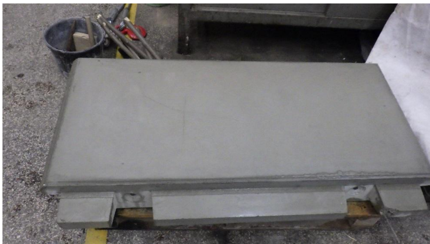
obr.40. Replika panelu před provedením kamenické úpravy
