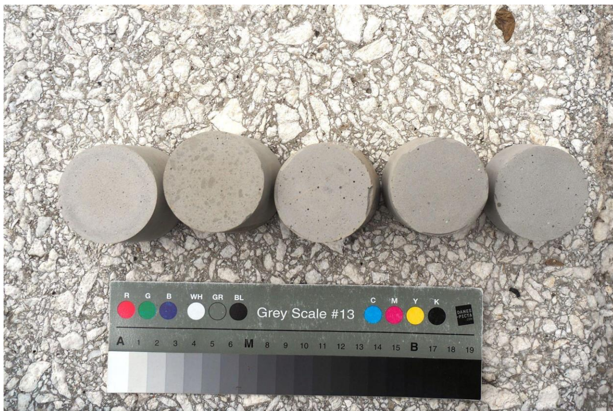
obr.48. Vzorčky cementů: 1. Portlandský směsný cement EN 197-1 - CEM II/B-M (S-LL) 32,5 R Českomoravský cement. 2. Portlandský směsný cement EN 197-1 - CEM I 42,5 R Českomoravský cement. 3. Portlandský směsný cement CEM II/B-M (S-V-LL) 32,5 Prachovice Cemex. 4. Portlandský cement CEM II/A-LL 32,5 R Schwenk. 5. Portlandský cement CEM II/A-LL 32,5 R Čížkovický cement.
