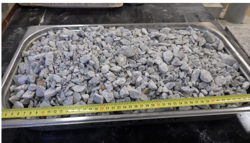
obr.34. Vápencová drť použita pro vytvoření repliky betonového dílce
