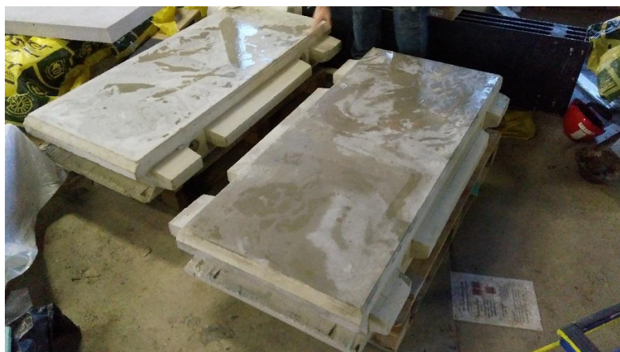
obr.39. Vyrobené panely po odformování
