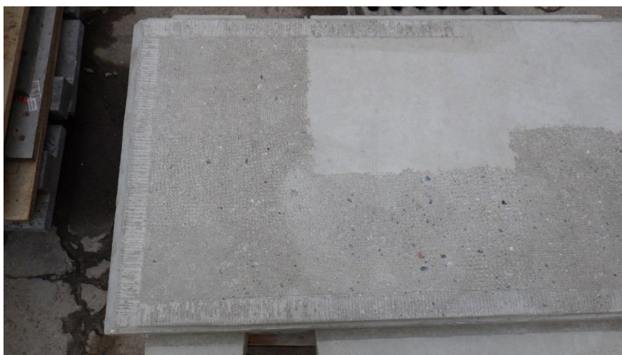
obr.42. Vzorok plochy s rúznou hĺbkou a hrúbkú opracovú na replice panelu z obyčejného betonu (bez bílého plniva)
