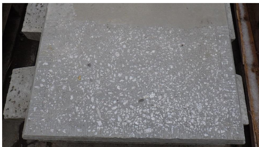
obr.43. Vzorek s vybraným typem hrubšího pemrlovúú obdobného jako u originálu
