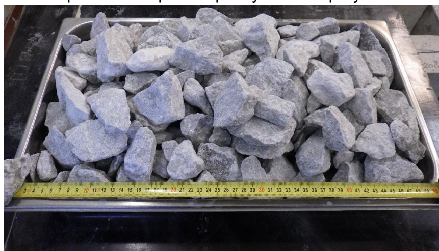
obr.35. Vápencová drť použita pro vytvoření repliky betonového dílce
